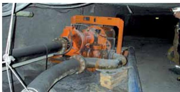
Насос HL160M (200 мм x 150 мм) с электроприводом и бесступенчатым регулятором скорости служит в качестве основного дренажного насоса в аварийных ситуациях на угольной шахте.
