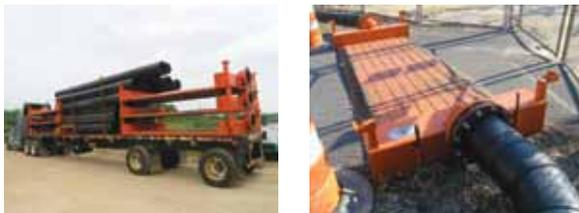
Дорожные эстакады компании Godwin обеспечивают возможность временной прокладки трубопроводов на промышленных и горнодобывающих объектах, в торговых и жилых районах, где требуется обеспечить проезд транспортных средств над трубопроводом.
